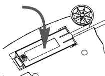
3. Das Schnittstellenmodul installieren.
